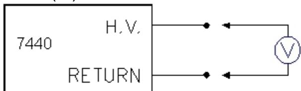
校正交(直)流電流連接方式
