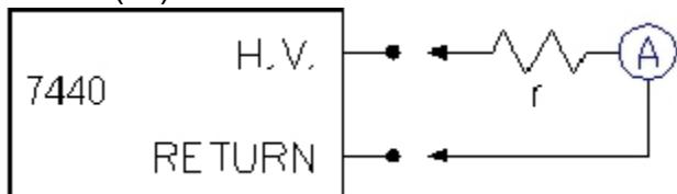
校正絕緣電阻連接方式
